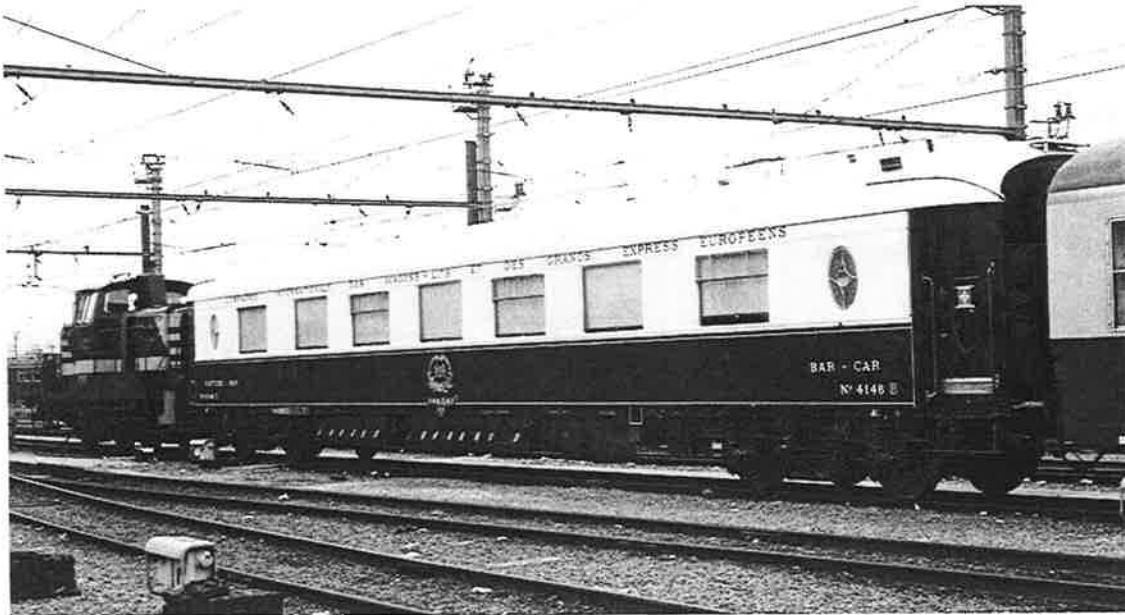
WSP type Côte d'azur n° 4148 à la CIWL, transformée en voiture-bar, vue à Forest-voitures le 21 février 1988 – Photo Guy Bridoux.
